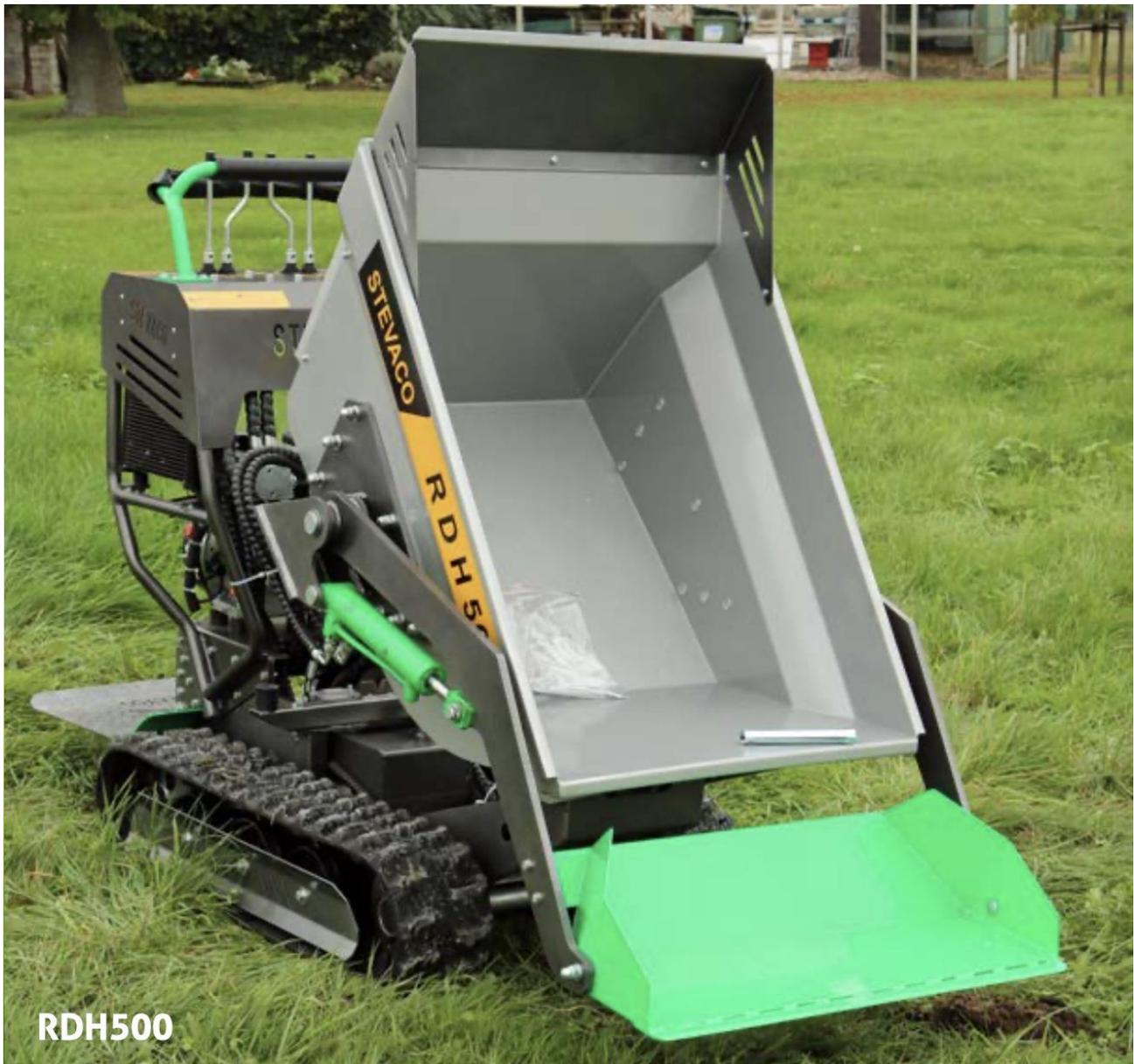
Ce mini tombereau hydraulique STEVACO est équipé d'un moteur essence. Cette brouette à essence fonctionne entièrement hydraulique et hydraulique d'inclinaison, le tout grâce à une opération simple. Le mini tombereau a une pelle avant en standard. Il s'agit d'un mini tombereau sur chenilles d'une capacité de chargement maximale de 500 kg. Il y a une plate-forme à l'arrière de la machine sur laquelle vous pouvez vous tenir debout. Voir d'autres données techniques dans la liste.
